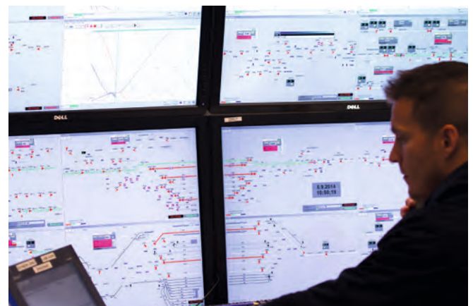
Bild 5: TAKO verfügt über Automatikfunktionen und Anpassungsfähigkeit zur Unterstützung der Fahrdienstleiter.
